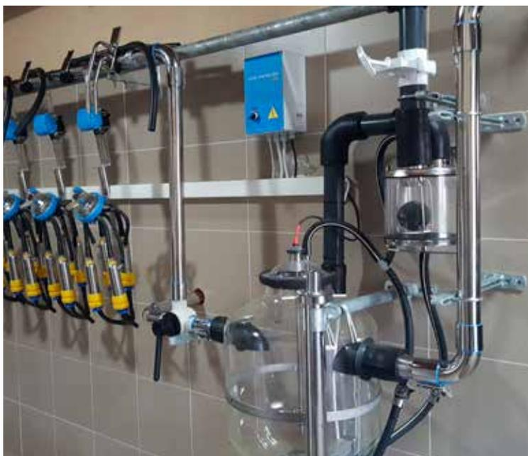
**CLEAN-O-TRONIC di Milkline** è sviluppata per aziende di medie e grandi dimensioni. Ciascuna fase di lavaggio è programmabile, per un processo di lavaggio versatile ed efficace.
